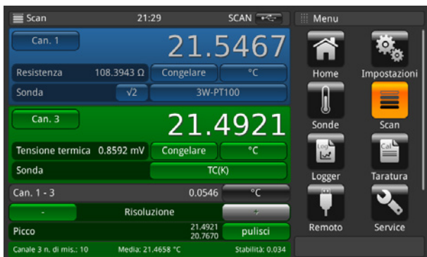
Vista di scansione/taratura: 2 canali selezionati
