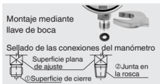
ejemplo, roscas NPT) el sellado se realiza en la rosca ②, con material de sellado complementario, como por ejemplo, cinta PTFE. El par de apriete depende de la junta utilizada. Para poner el instrumento de medición en la posición que proporcionará la mejor lectura, se recomienda una conexión con un manguito tensor o
