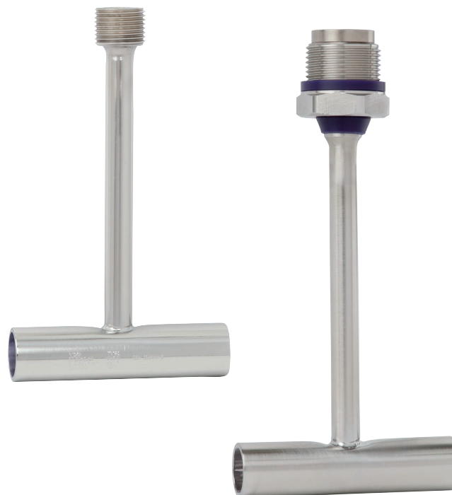
Fig. esquerda: Rosca G 3/8 para modelo TR21-B Figura direita: Conexão rosqueada M24 para modelo TR22-B Opção: Combinação de vedação no niple de extensão
