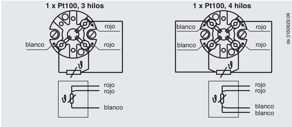
Consultar las conexiones eléctricas de los transmisores de temperatura incorporados en las correspondientes hojas técnicas o en los manuales de instrucciones.
