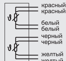
2 x Pt100, 4-проводная схема соединения
