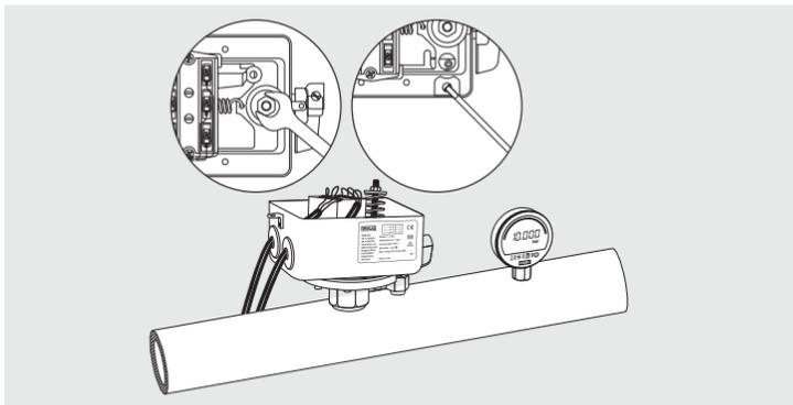
1. Druckschalter Typ PSM-530, Druckreferenz und Druckerzeugung an ein gemeinsames Drucksystem anschließen.
