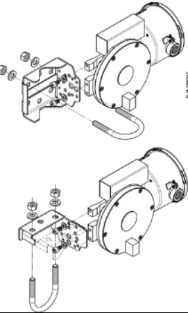
图 16 - 安装示例
