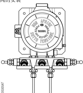
图 20 - DW496/DW197 和 DA496/DA197 型隔膜密封仪表
