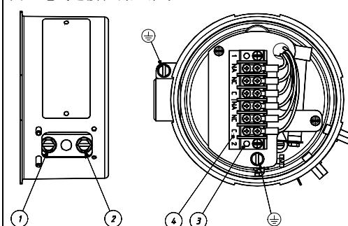
1 - 微动开关 2 设定点校准螺钉
