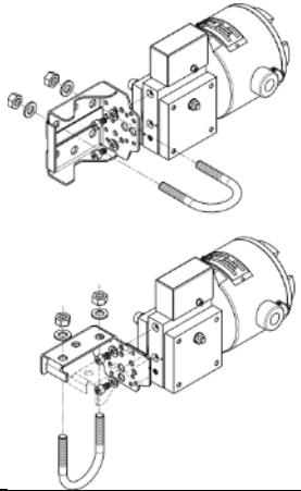
图 15 - DW10-DA10-2"管道支架的安装
