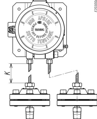
图 22 - 直接歧管阀的安装 (1/2G 螺纹)
