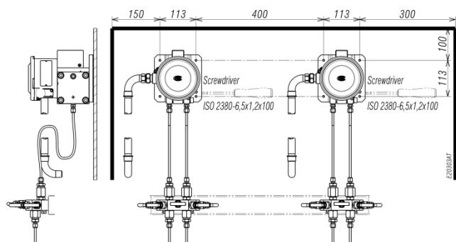
图 21 - 法兰歧管阀的安装
