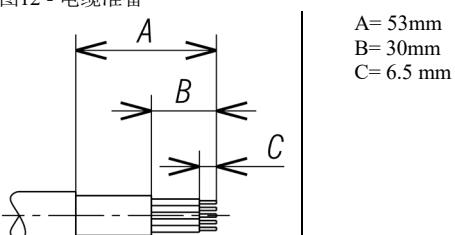
单根剥离导线必须与每个触针压接。对于电气连接和装配，请遵循图 13。
